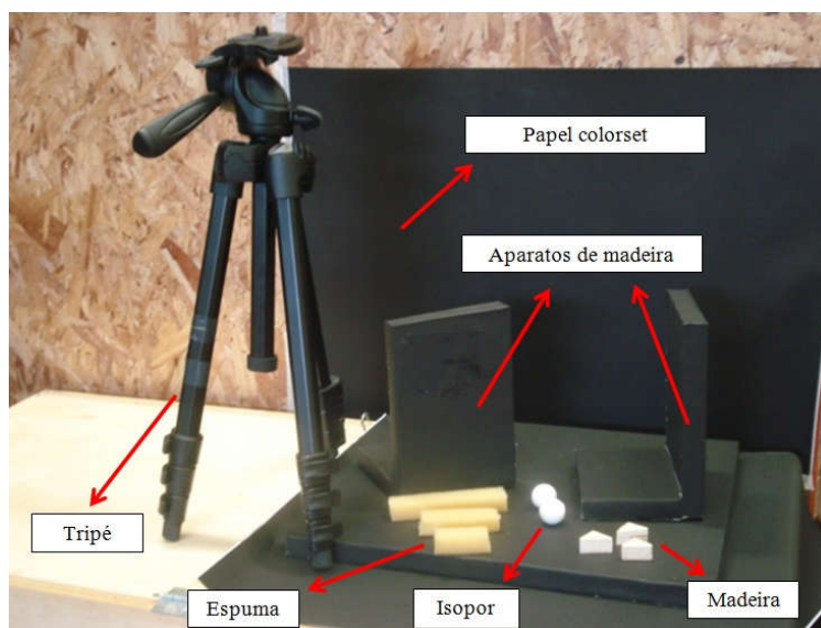
Figura 2 – Aparato instrumental e materiais utilizados na montagem dos modelos qualitativos.
